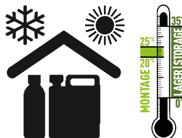
Abb. 7: Lagerung und Verarbeitung Muffenschaum
